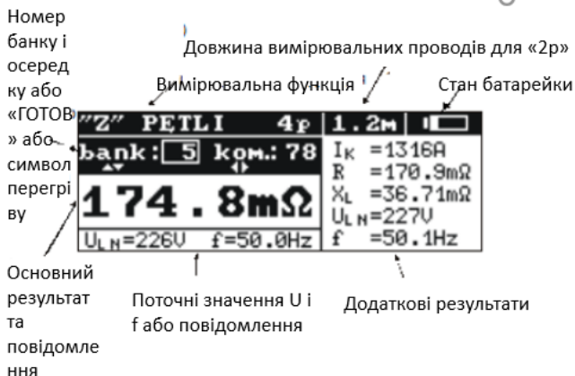
Мал.3 Організація екрану при вимірюванні імпедансу петлі короткого замикання (всі результати)
