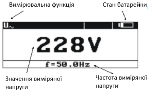
Мал.12 Вимірювання змінної напруги - результат
