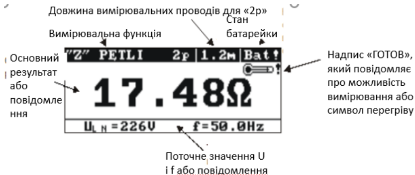
Мал.3 Організація екрану при вимірюванні імпедансу петлі короткого замикання (всі результати)
