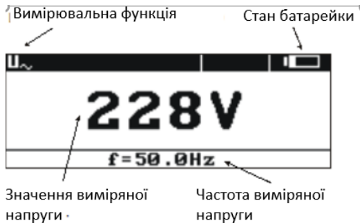
Мал.2 Організація екрану при вимірюванні змінної напруги
