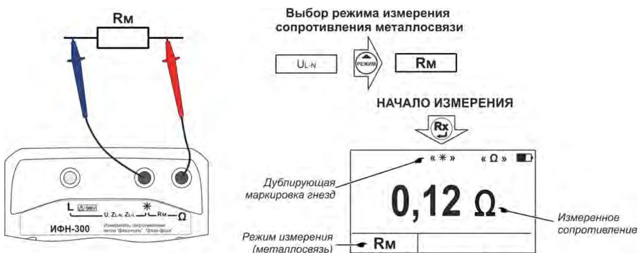
Рисунок 2.7 - Измерение сопротивления металlosвязи
