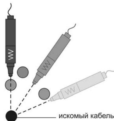
Рисунок 5.4.2 – Поиск кабеля (жилы) по минимуму сигнала
