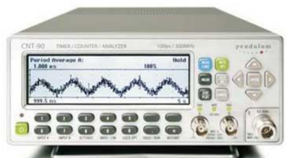
Рисунок 5: Дисплей с отображением тренда (изменения сигнала во времени) выбранных данных.
