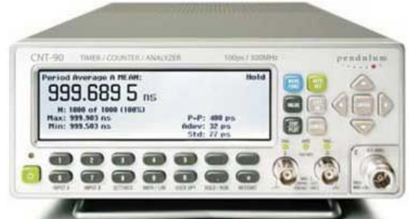
Рисунок 4: Дисплей с различными статистическими параметрами, просматриваемыми одновременно.
