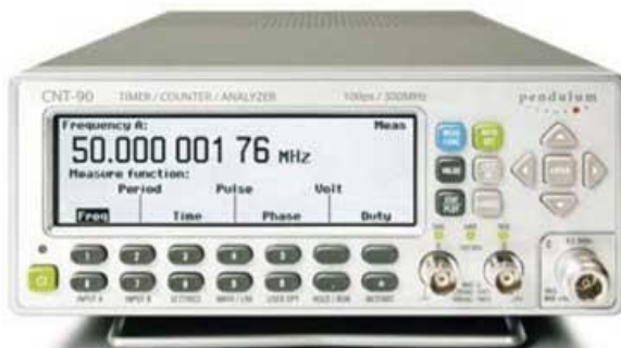
Рисунок 2: Меню выбора функции измерения, показано с результатами измерений.
