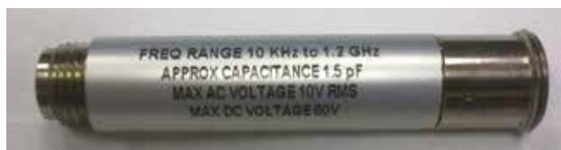
Измерительный зонд 952001 (диапазон частот от 10 кГц до 1,2 ГГц)
