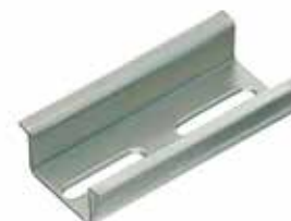
TS 35/15 мм согласно EN 50022 (s = 1,5 мм)
