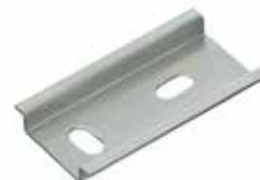
TS 35/7,5 мм согласно EN 50022 (s = 1,0 мм)
